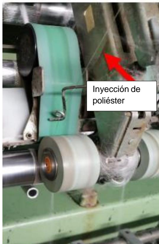
*Figura 4.33 Inyección de poliéster al hilo.*
