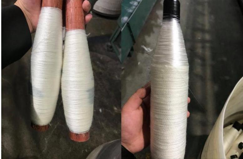
Figura 4.14 Canillas con bajo peso y con inyección solamente de poliéster en la parte superior.
