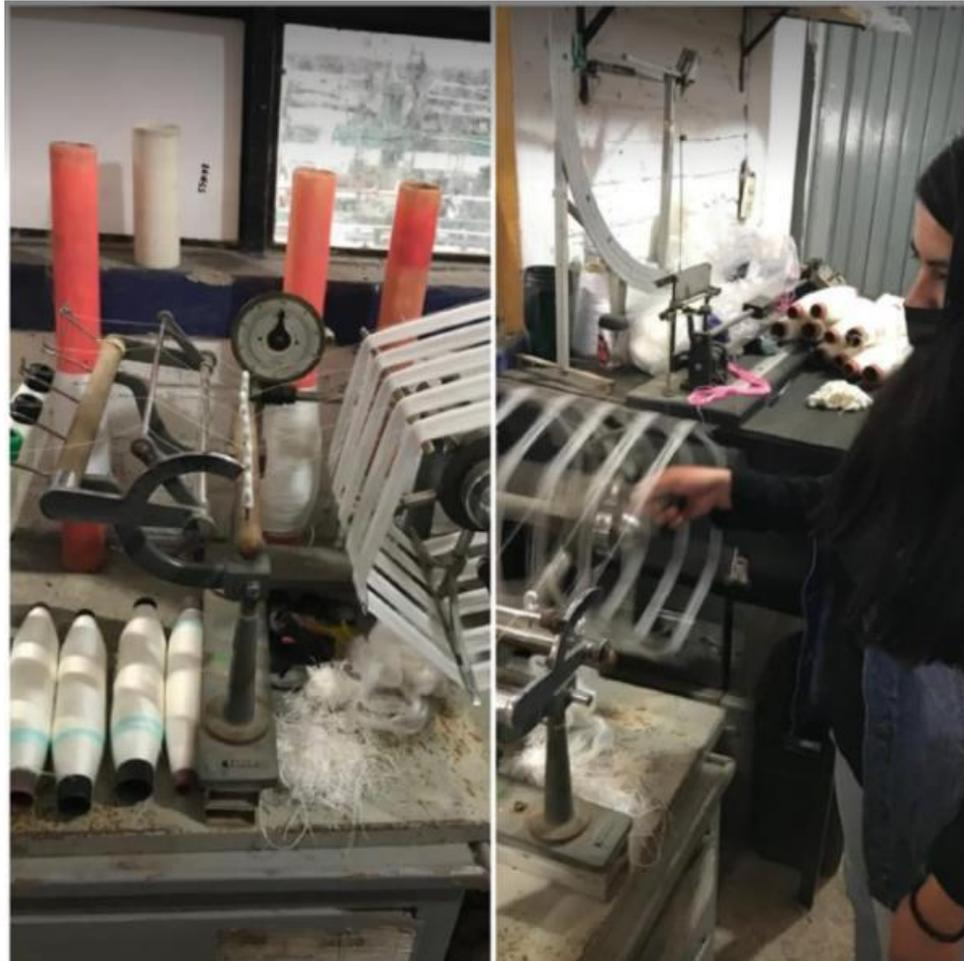
*Figura 4.7 Máquina Asped para obtener muestra de madejas pequeñas de hilo.*
